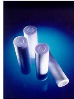
STARLIFE è un filtro di profondità interamente realizzato in polipropilene con tecnologia Melt Blown. Le microfibre che costituiscono la matrice filtrante sono disposte in modo da ottenere strati a porosità decrescente dall'esterno verso l'interno per abbinare ad un grado di filtrazione con una efficienza del 98 % una elevata capacità di accumulo del contaminante ed il mantenimento della portata di fluido da filtrare.
